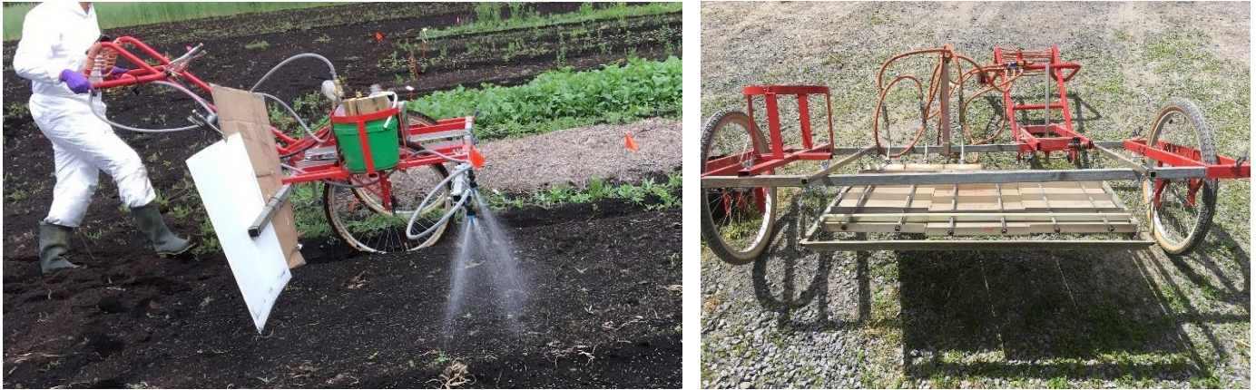
Figure 2.11 Pulvérisateur avec buses Twinjet (à gauche) et pyrodésherbeur (à droite), montés sur le porte-outils Weed Master.
