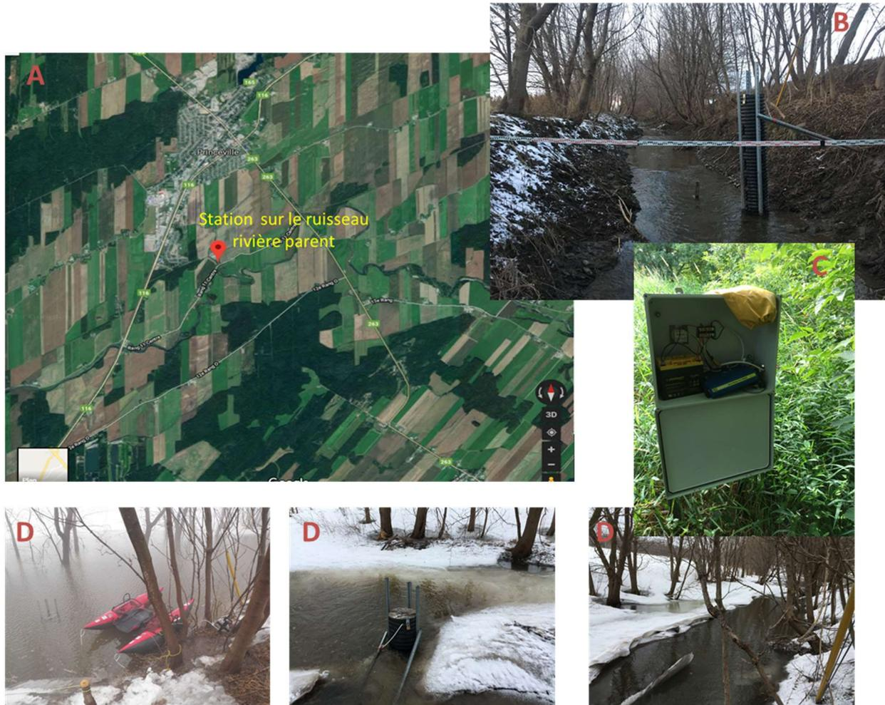
**Figure 3. Localisation (a) et dispositifs de mesures hydrométriques à la station Parent, incluant le courantomètre à effet doppler installé au fond de la section d'écoulement et la sonde multi-paramètres installée dans le cylindre de PVC (b), et le boîtier électrique (panneau solaire intégré; C). Aussi, photographies de la station en crue lors du redoux de février 2018 (d).**
