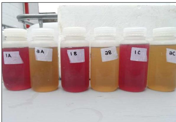
**Figure 6. Échantillons prélevés 4 jours après le début de l'aération dans chacun des bassins lors de l'essai 1. Les échantillons 1(A,B,C) sont non aérés et 2(A,B,C) étaient aérés au taux de 0,02 Lair/Leau-min.**
