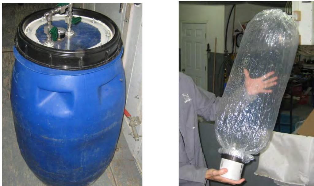
**Figure 3. Le poumon artificiel (gauche) et les sacs de 60 L en Nalophan<sup>®</sup> (droite) utilisés**
