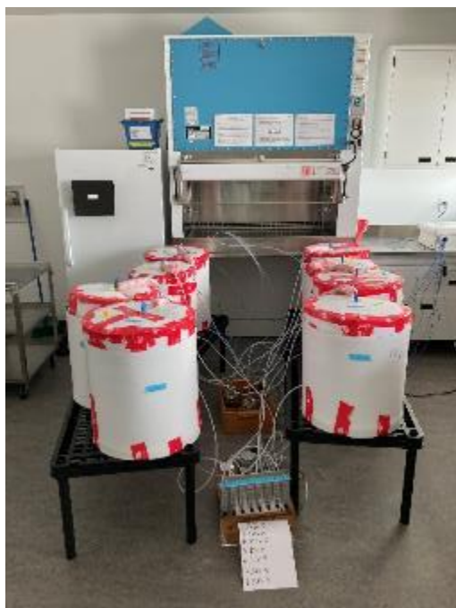
Figure 4. Biodigesteurs expérimentaux utilisés pour composter la litière en conditions contrôlées.
