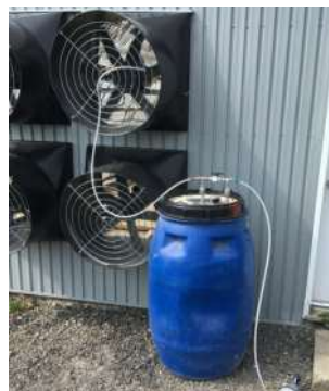
Figure 7 : Échantillonnage dans des sacs d'air pour l'analyse d'odeur
