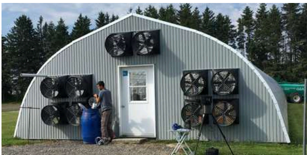
Figure 7 : Échantillonnage dans des sacs d'air pour l'analyse d'odeur
