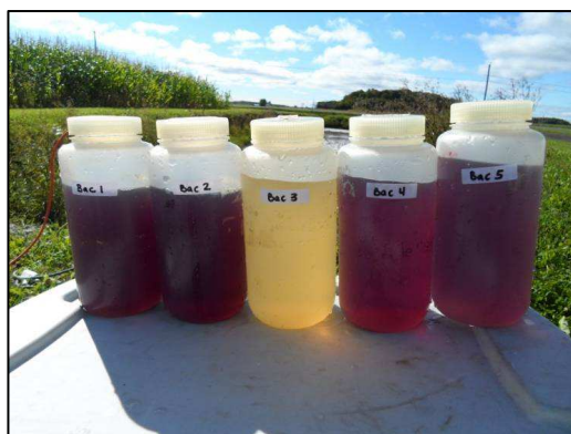
Figure 5. Couleur dans les cinq unités de sédimentation après 36 heures sans nouvelle entrée d'eau. Le bac 3 était aéré en tout temps.
