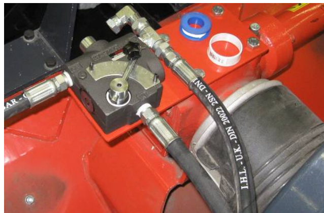
Figure 17. Valve de réglage du débit en option (modèle S-056375-FLOW CONTROL)
