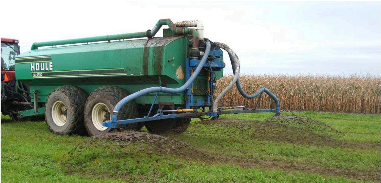
**Figure 5.** Équipement utilisé lors des essais au site A, muni d'une rampe basse Pro-Jet
