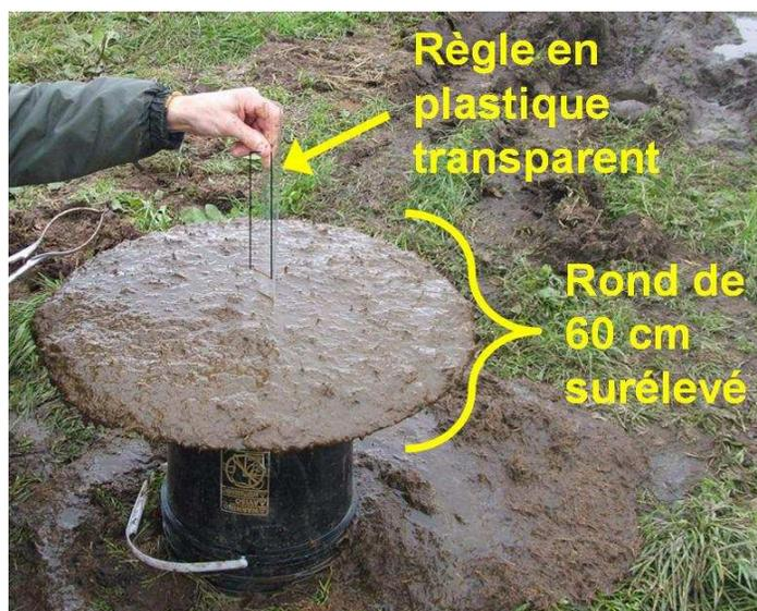
Figure 3. Prise de la mesure d'affaissement
