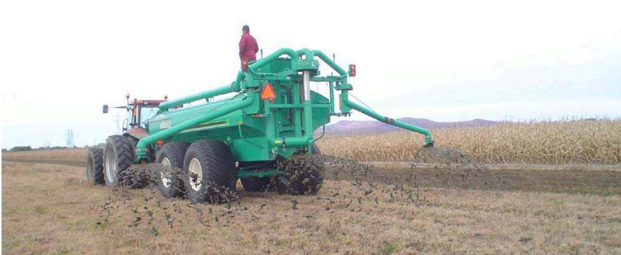
**Figure 8. Équipement utilisé lors des essais au site B, muni d'une rampe basse Houle**
