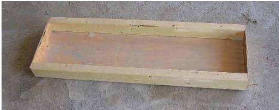
**Figure 2. Support en bois pour l'insertion des plats d'aluminium**
