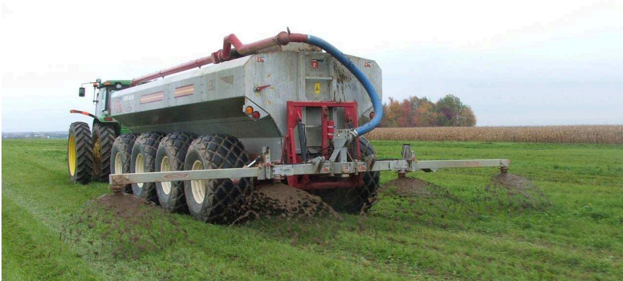
**Figure 6. Équipement utilisé lors des essais au site A, muni d'une rampe basse DM**
