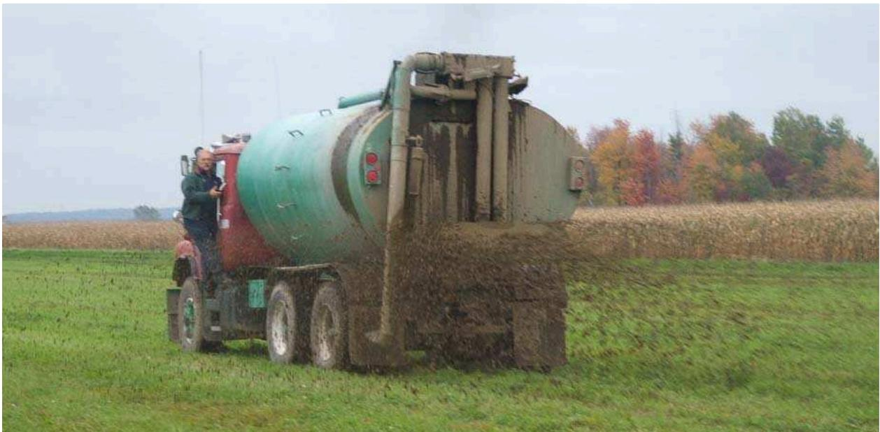
**Figure 7. Équipement utilisé lors des essais au site A, muni d'un équipement pour aérospersion basse Houle montée sur un camion**
