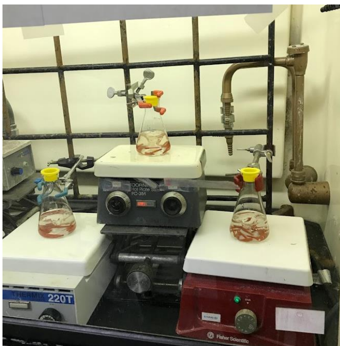
Figure 3. Agitation pendant 4 heures d'un diffuseur coupé en morceaux puis placés dans l'acétone afin d'extraire la codlémone
