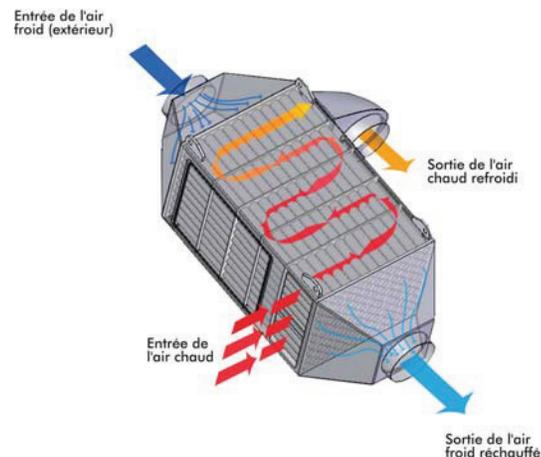
Figure 1. Circuits d'air chaud et froid de l'échangeur.
