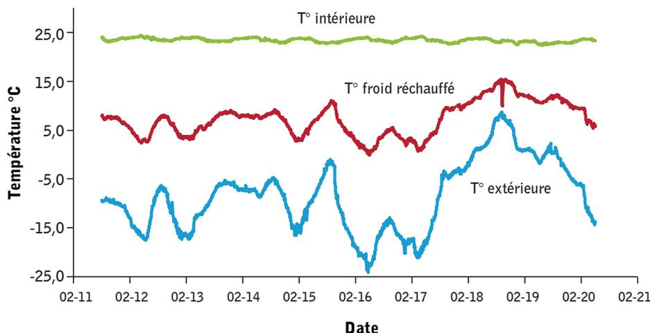
Figure 2. Variation de la température de l'air à l'entrée et à la sortie du POLYMAIR<sup>MD</sup> dans un poulailler d'œufs d'incubation du Nouveau-Brunswick en février 2008.
