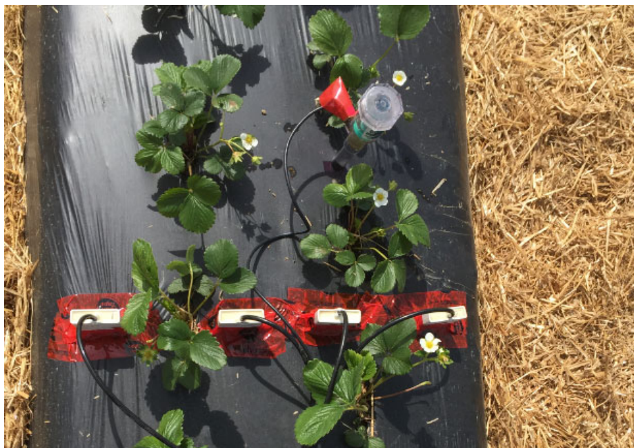
Figure 3. Sondes de teneur en eau et tensiomètre utilisés, parcelle phare Fraises à JN
