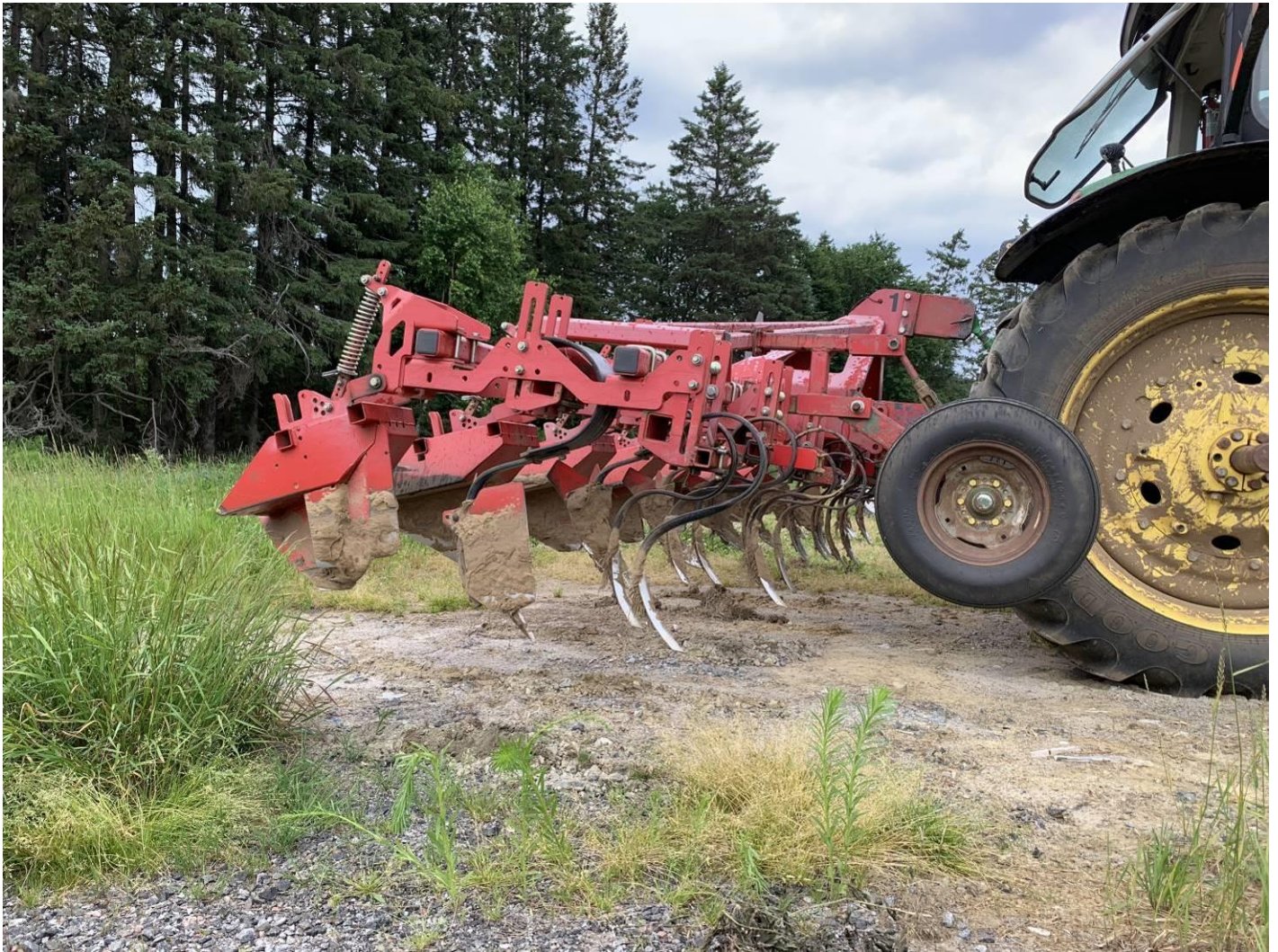
Figure 28. Dents incurvées du renhausseur Grimme 6 rangs, saison 2019.
