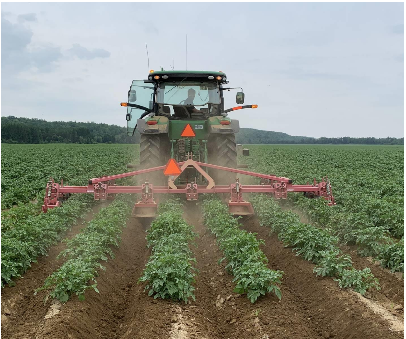
Figure 27. Renhausseur Grimme GH6 à 6 rangs modifié, saison 2019.
