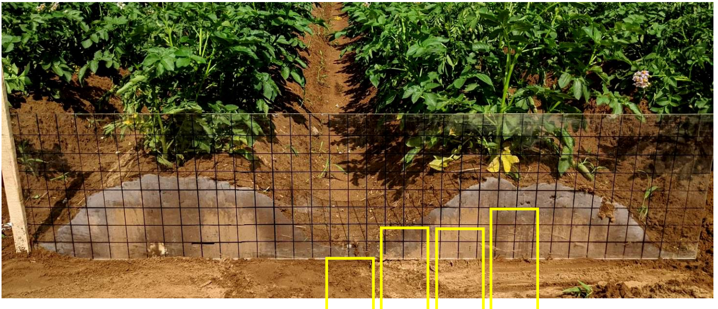
Figure 5. Portée des 4 sondes TDR représentée par un cadre sur une coupe transversale d'une Butte conventionnelle le 28 juillet 2020.
