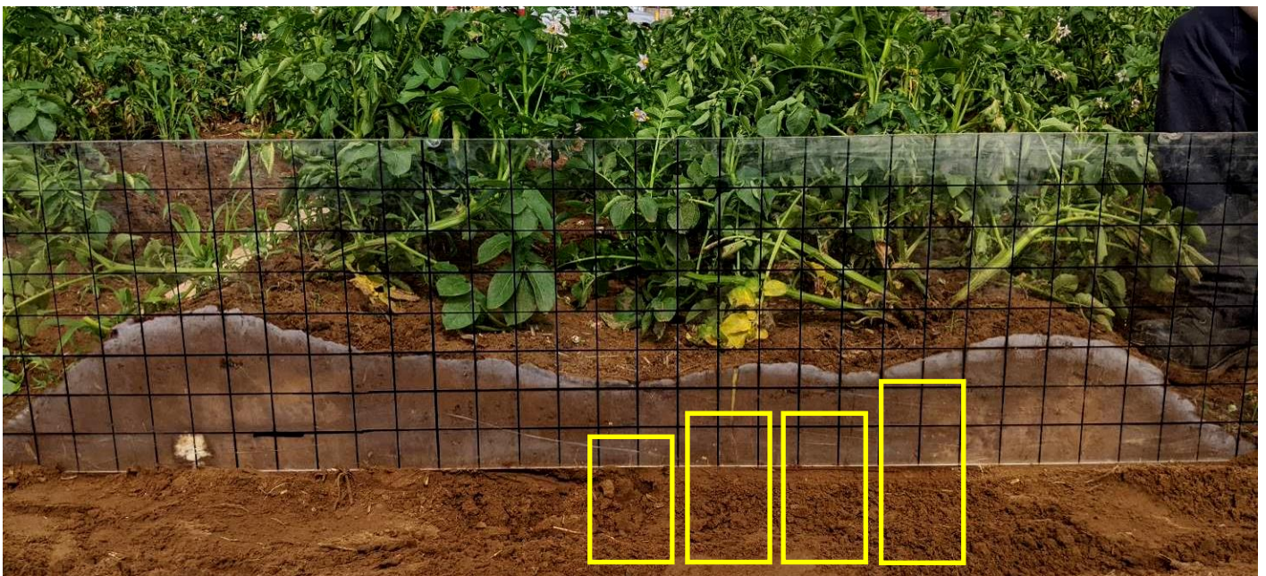
Figure 6. Portée des 4 sondes TDR représentée par un cadre sur une coupe transversale d'une Butte 2.0 le 28 juillet 2020.
