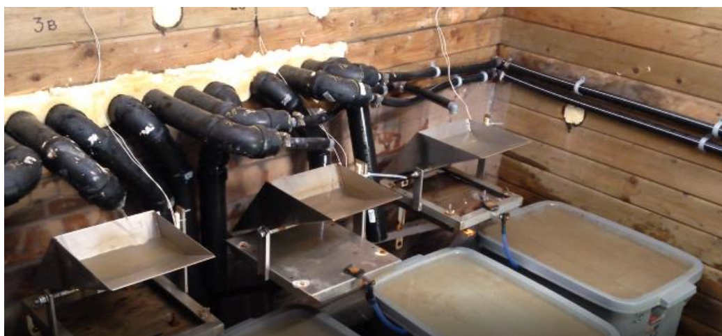
Figure 4 Système de mesure de débit et d'échantillonnage de l'eau de drainage et ruissellement
