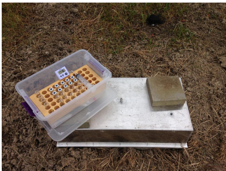
Figure 6: Chambre statique pour mesure du \text{N}_2\text{O}
