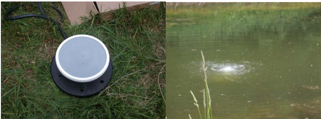
Figure 6. Diffuseur d'air à membrane (à gauche) et mouvement de l'eau créé lors de l'aération.
