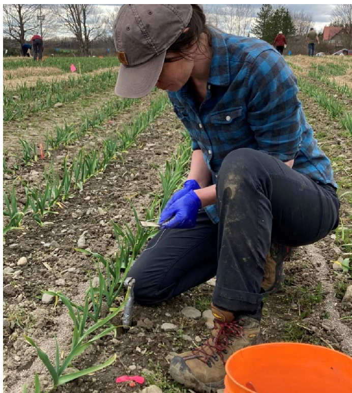
Figure 6. Pose de la membrane d'échange ionique à proximité des plants pour le suivi in situ du N et du P.
