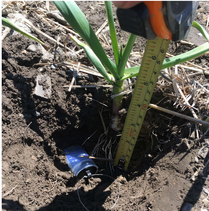
Figure 5. Sonde de température HOBO installée légèrement sous le caïeu.
