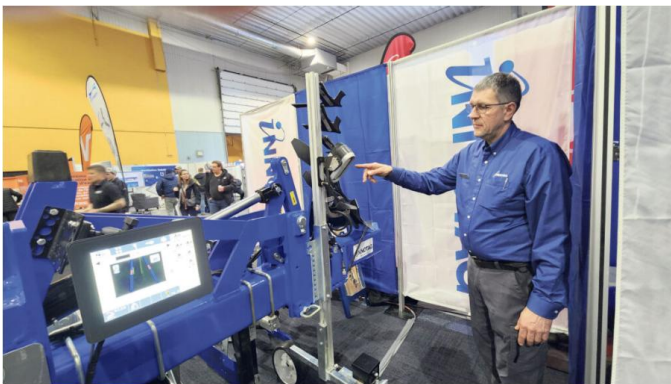
Vincent Machabée explique comment une caméra installée directement sur l'outil de travail permet ensuite, avec une technologie d'intelligence artificielle, de traiter en temps réel des informations comme la couleur ou la hauteur de la végétation pour désherber entre les rangs avec une très grande précision.
