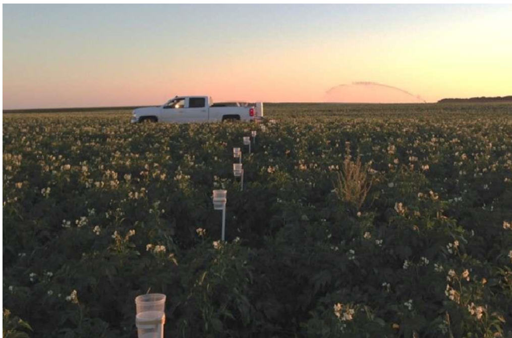
Figure 13. Mesure de hauteur d'eau par aspersion avec canon (diagnostic pommes de terre, Capitale-Nationale 2016).
