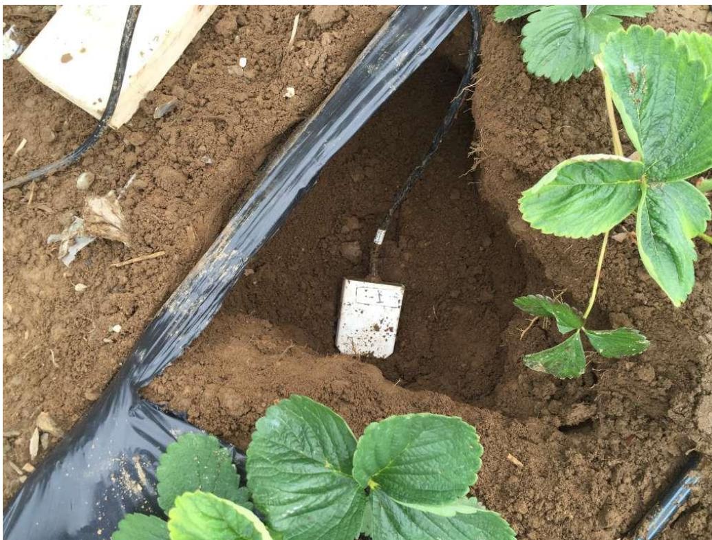
Figure 3. Installation d'une sonde de teneur en eau (TDR) (caractérisation du sol Fraises, Chaudière-Appalaches 2016).
