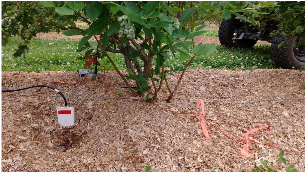
Figure 10. Installation de sonde de teneur en eau et tensiomètre (caractérisation du sol bleuets en corymbe, Capitale-Nationale 2016).
