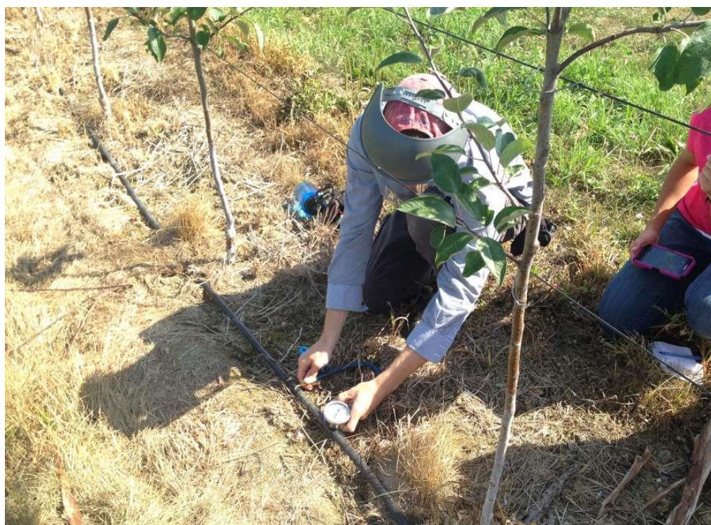
Figure 2. Prise de pression avec tube de Pitot sur tubulure goutte à goutte (diagnostic pommes, Montérégie 2016).
