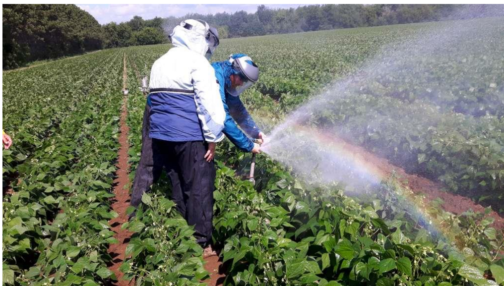
Figure 1. Prise de pression avec tube de Pitot sur un gicleur (diagnostic haricots extra-fins, Lanaudière 2016).
