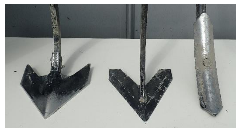
Figure 1. a) Soc à pattes d'oie, b) plats, c) étroits
