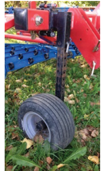
La profondeur du travail est ajustée à l'aide de la roue de terrage.
