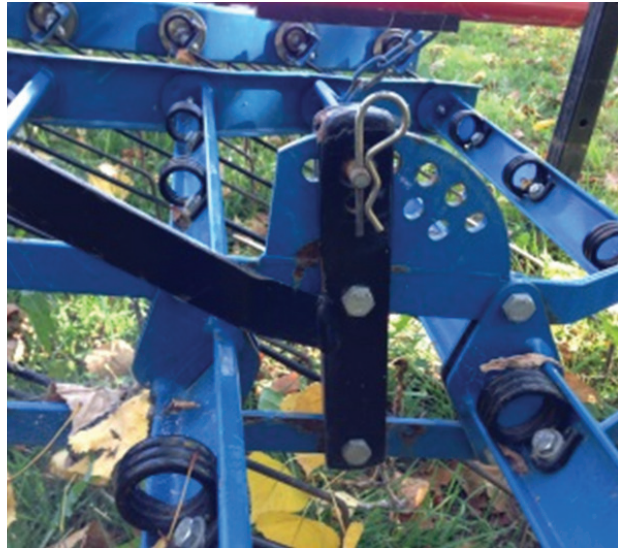
La tension des dents est réglée au moyen d'un levier qui peut positionner les dents à différents angles.
