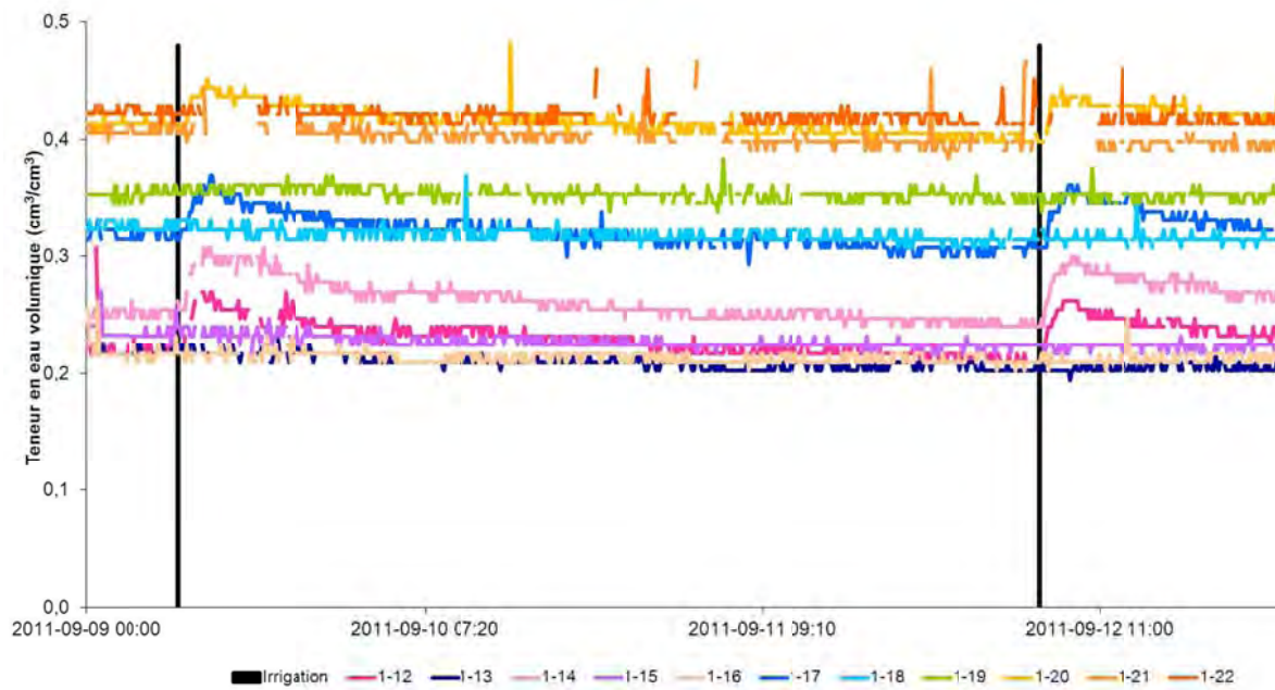
Figure 12. Variations de la teneur en eau volumique des sondes 1-12 à 1-22 du 9 au 12 septembre 2011.
