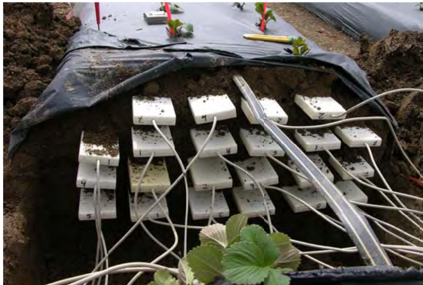
Figure 2. Installation des 22 sondes TDR dans la butte de sol, champ 1.
