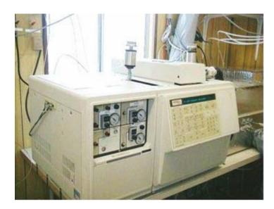
Figure 14. Chromatographe en phase gazeuse utilisé lors de l'essai supplémentaire réalisé à l'IRDA.
