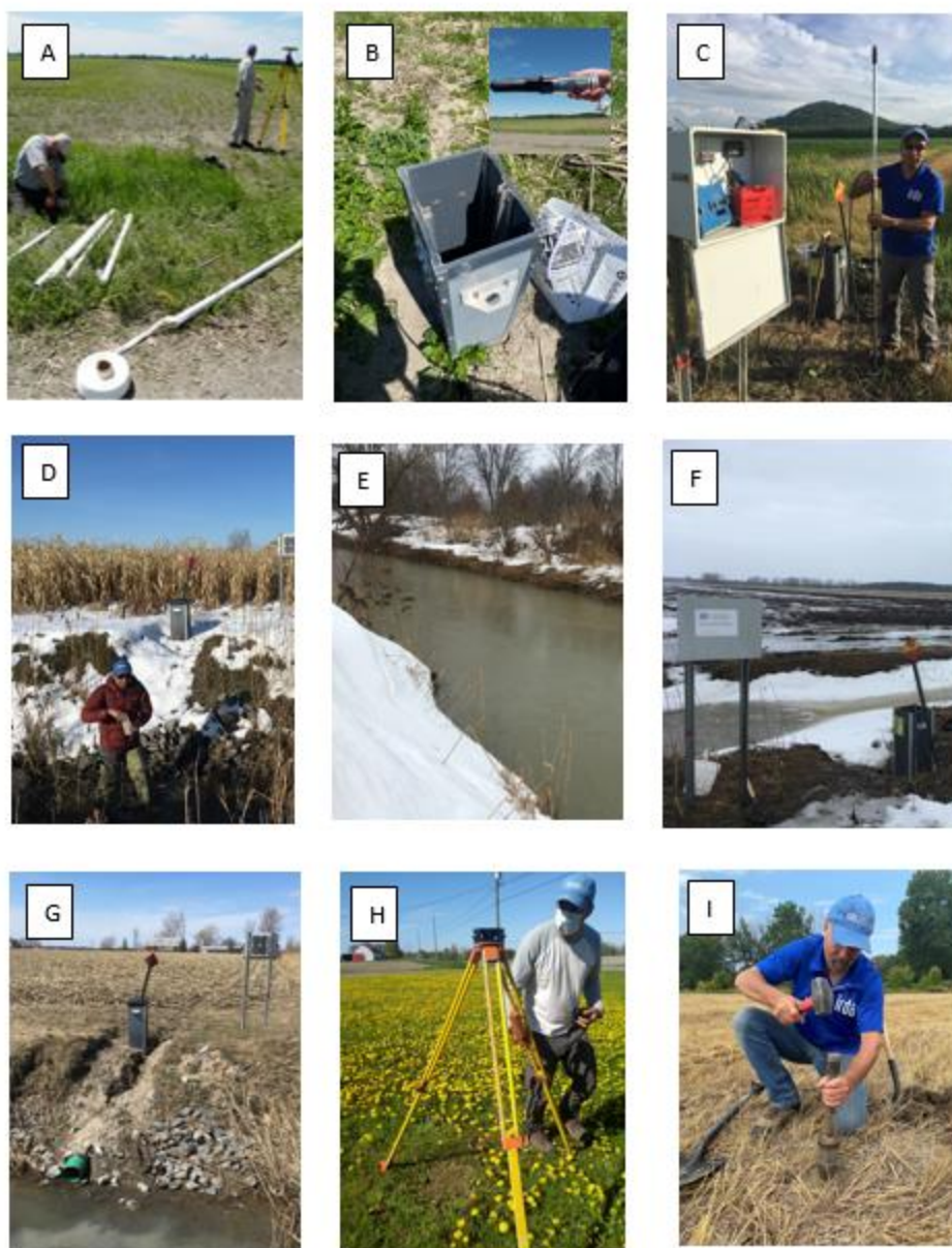
Figure 3-2 Confection des piézomètres (A); dispositif expérimental : chambre de contrôle de drainage, sonde de pression et sonde acoustique (B, C); échantillonnage en novembre 2019 (D); rivière des Hurons (E) et station du site B (F) en mars 2020; station du site B au printemps 2020 (G); relevés RTK lors du démantèlement des sites (H) et échantillonnage des cylindre de sol à l'automne 2021 (I).
