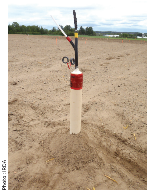
Figure 1. Lysimètre à suction d'une longueur de 0,93 m (modèle 1900L36 BO2M2 d'Hoskin Scientific) installé dans une culture de pommes de terre pour permettre le captage de l'eau lessivée et doser le \text{N-NO}_3 qu'elle contient
