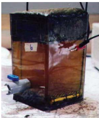
Unité de traitement par électro-flottation illustrant la séparation solide/liquide d'un lisier de porc provenant de la préfosse.
