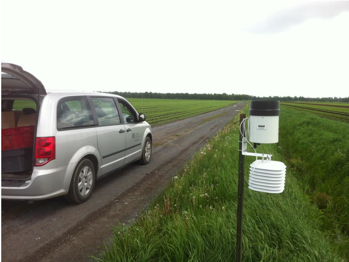
Photographie 1. Installation du pluviomètre et de l'écran de protection (radiation solaire).
