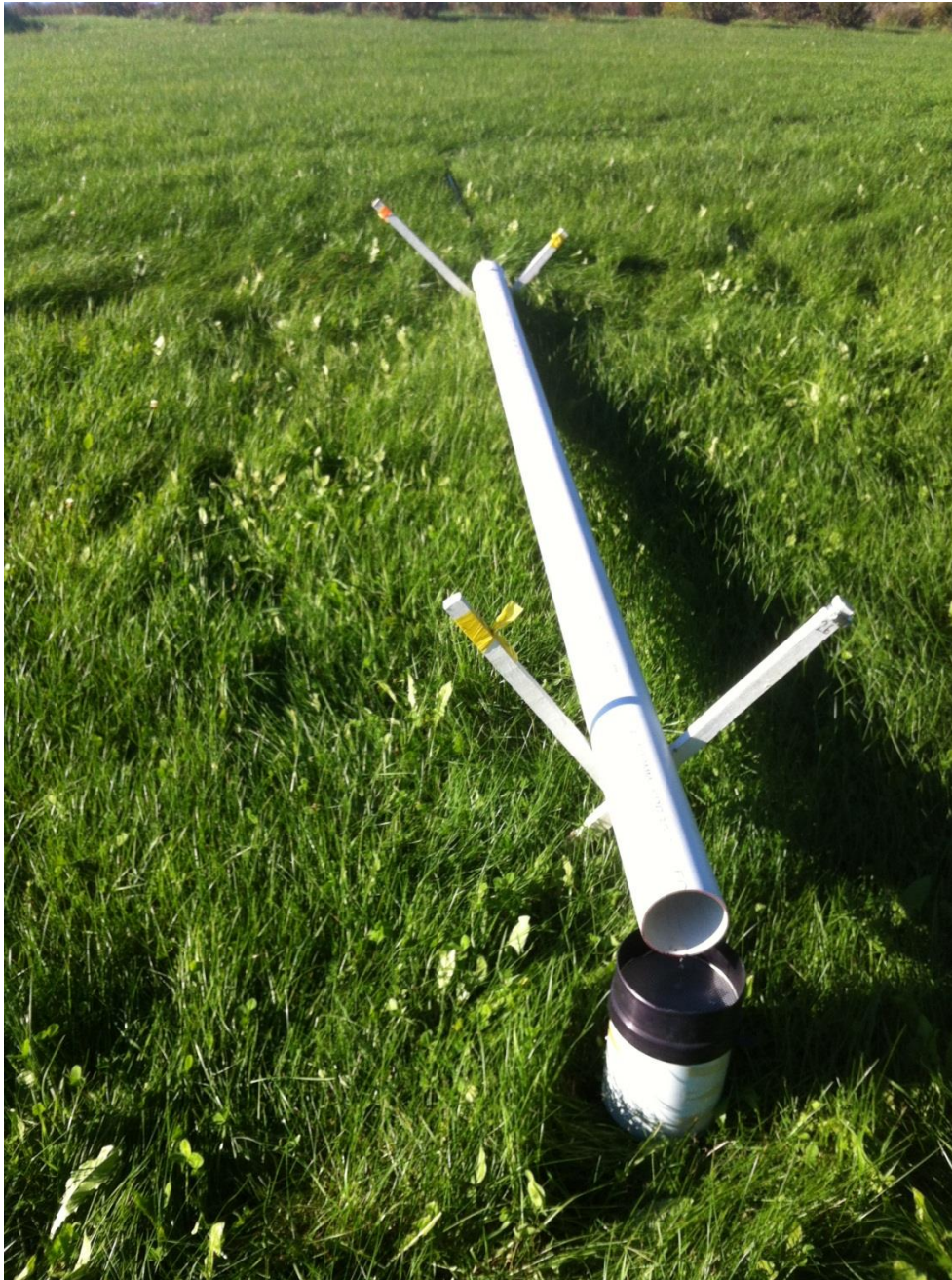
Photographie 9. Mesure du débit d'un tube de goutte à goutte à l'aide d'un pluviomètre.
