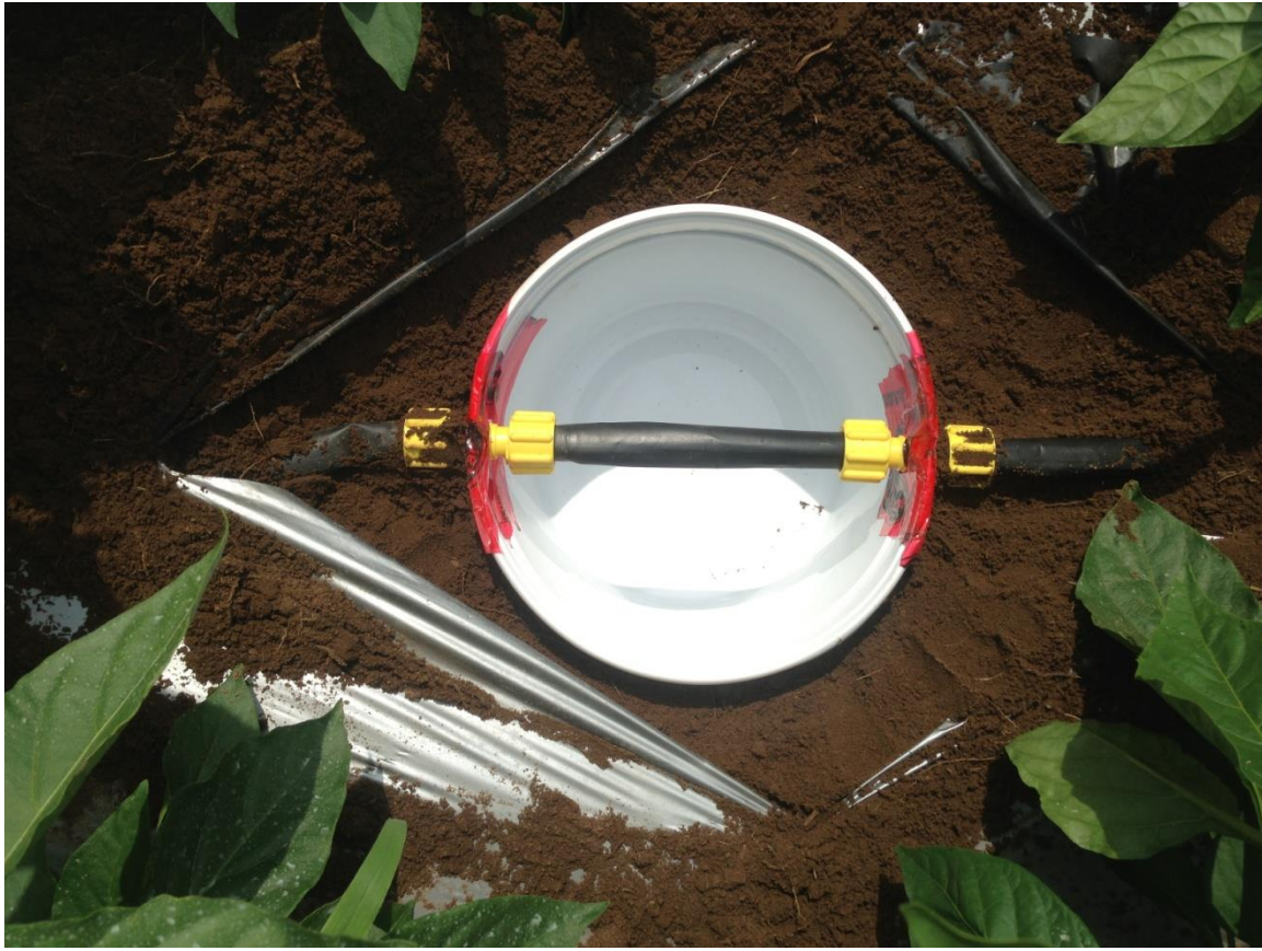
Photographie 7. Récipient utilisé pour mesurer le débit pratique d'un tube de goutte à goutte.
