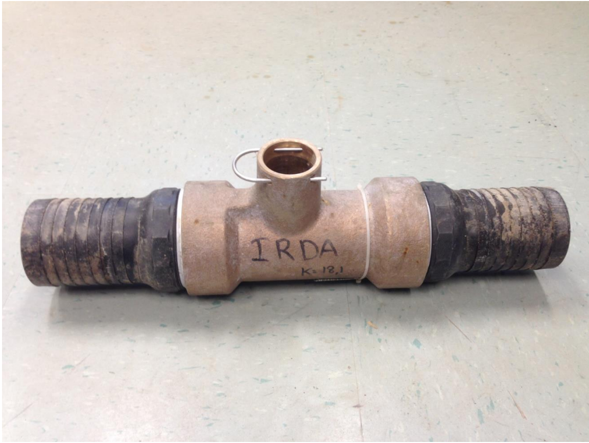
Photographie 5. Raccord en laiton en forme de T pour le compteur d'eau.
