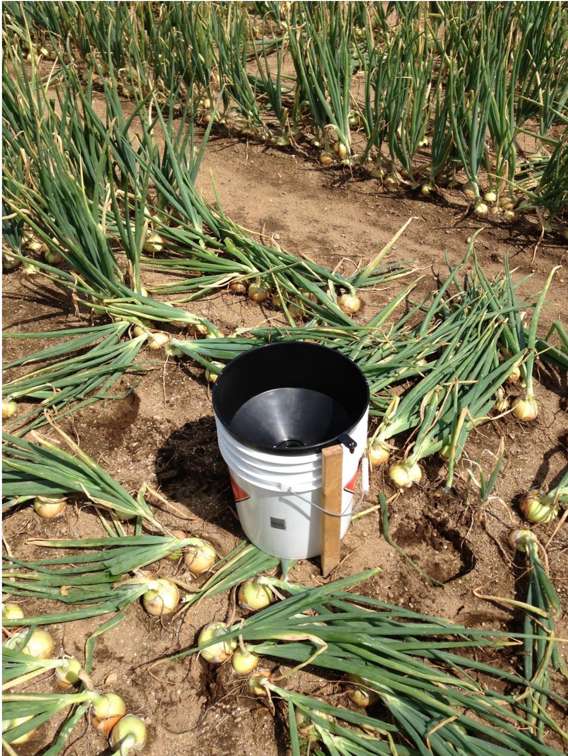
Photographie 10. Pluviomètre maison « Pluviodièrè » utilisé dans le cadre des tests d'uniformité.
