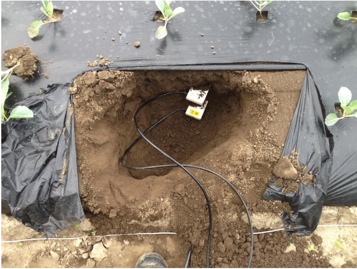
Photographie 3. Installation des sondes TDR à l'intérieur d'un sol butté recouvert de paillis de plastique noir.
