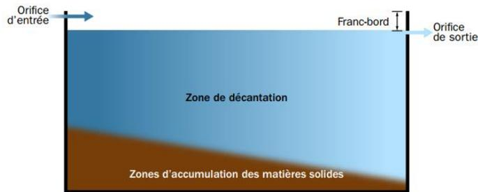
Figure 6. Schéma conceptuel d'un bassin de décantation classique (Visser et al., 2017)
