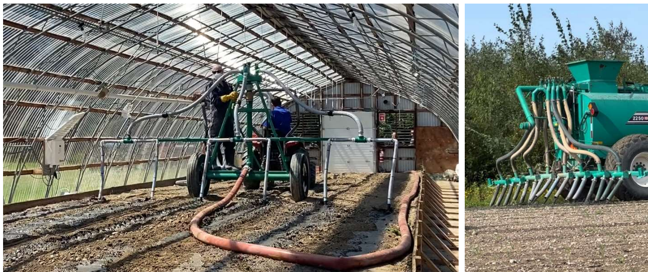
Figure 26 Rampe de pendillard conçue pour l'utilisation dans la serre (gauche) et rampe pendillard commercial (16 tuyaux).
