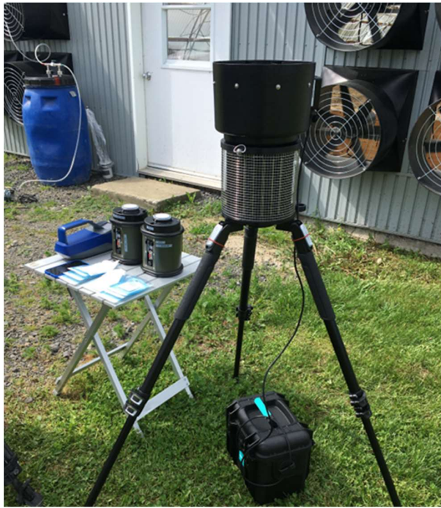
Figure 3 Appareils d'échantillonnage. De gauche à droite : Poumon artificiel pour l'échantillonnage de sacs d'odeurs; DustTrak Environmental Monitor 8543 (particules); deux SASS® 3100 et un SASS® 4100 sur trépied pour l'échantillonnage de bioaérosols.
