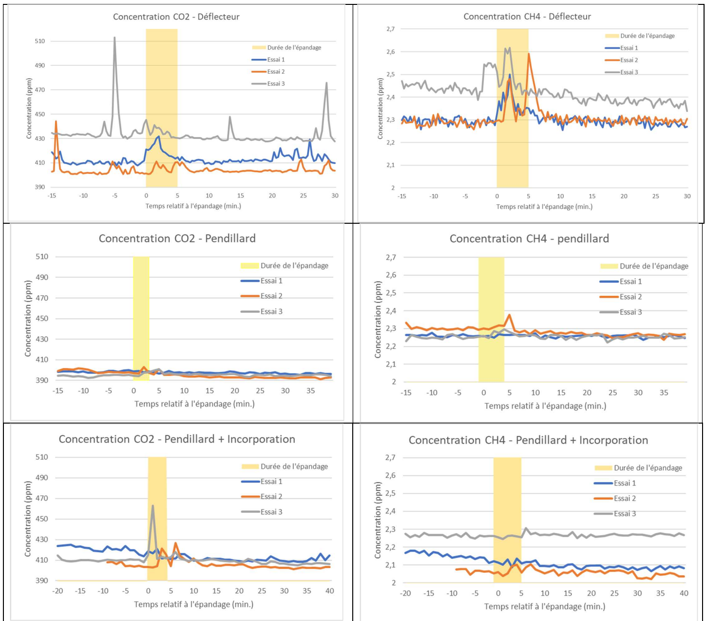
Figure 11 Concentration de CO 2 et de CH 4 lors de l'épandage de lisier au champ.
