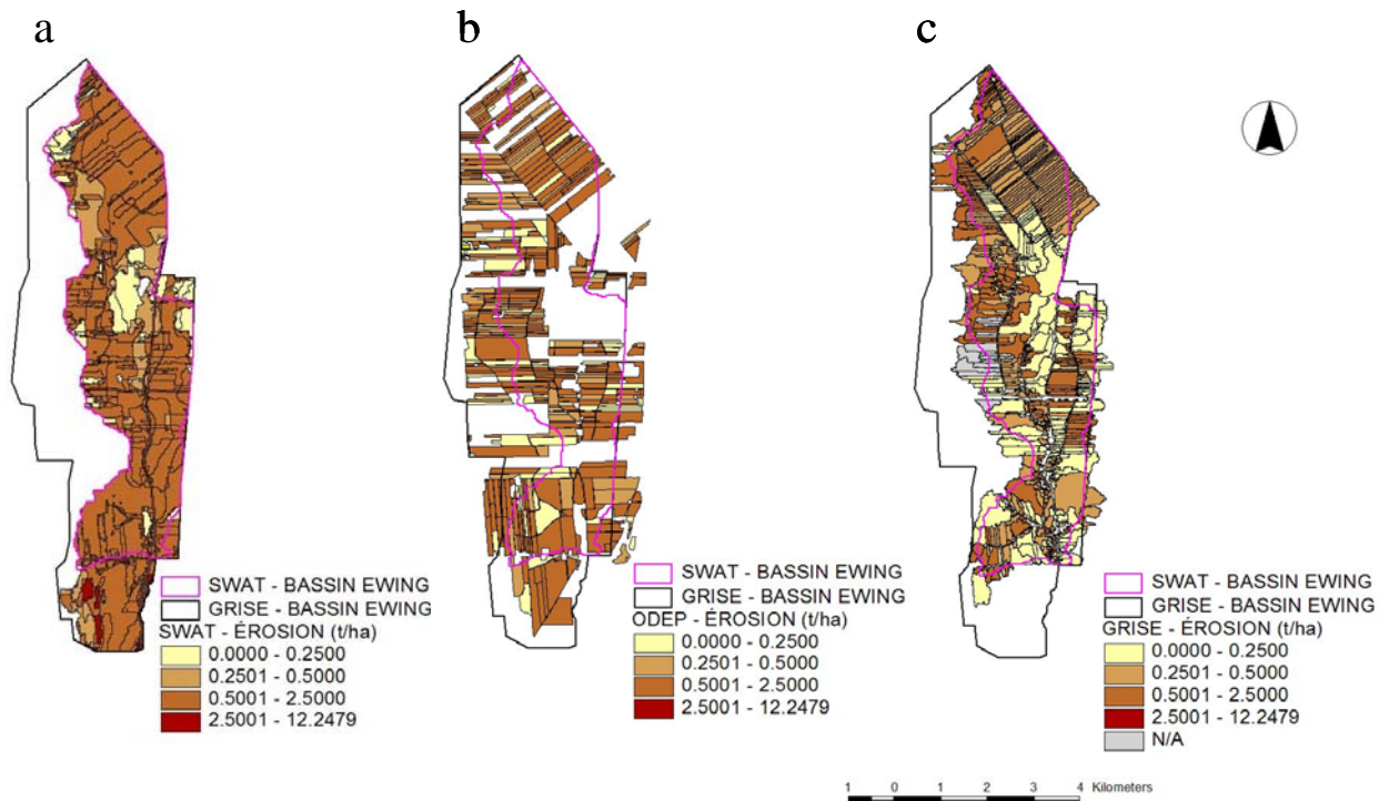
Figure 3.2. Représentation spatiale des taux d'érosion prédits à l'échelle des unités de réponse hydrologique avec le modèle SWAT calibré à l'échelle du bassin versant de la rivière Aux Brochets (a), à l'échelle de la parcelle avec l'outil de diagnostic des exportations de phosphore (ODEP) (b) et à l'échelle des micro-bassins sur la base des données de l'atlas agroenvironnemental GRISE.
