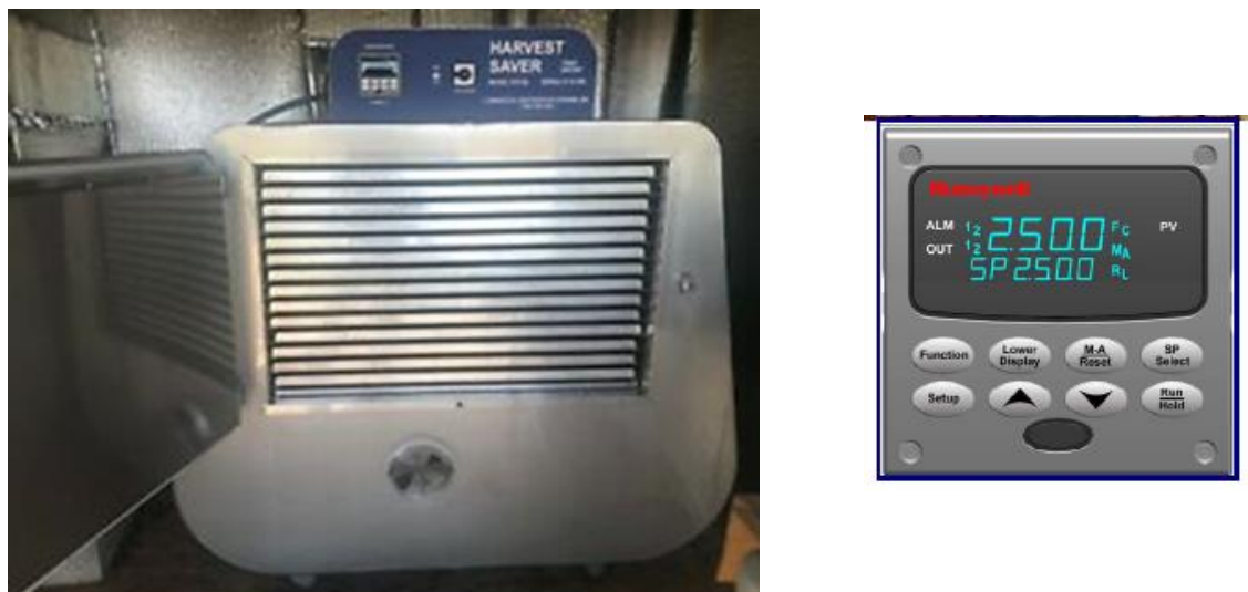
Figure 10. Unité de séchage thermique HARVEST SAVER 5A avec module de commande et contrôle Honeywell UDC 2500
