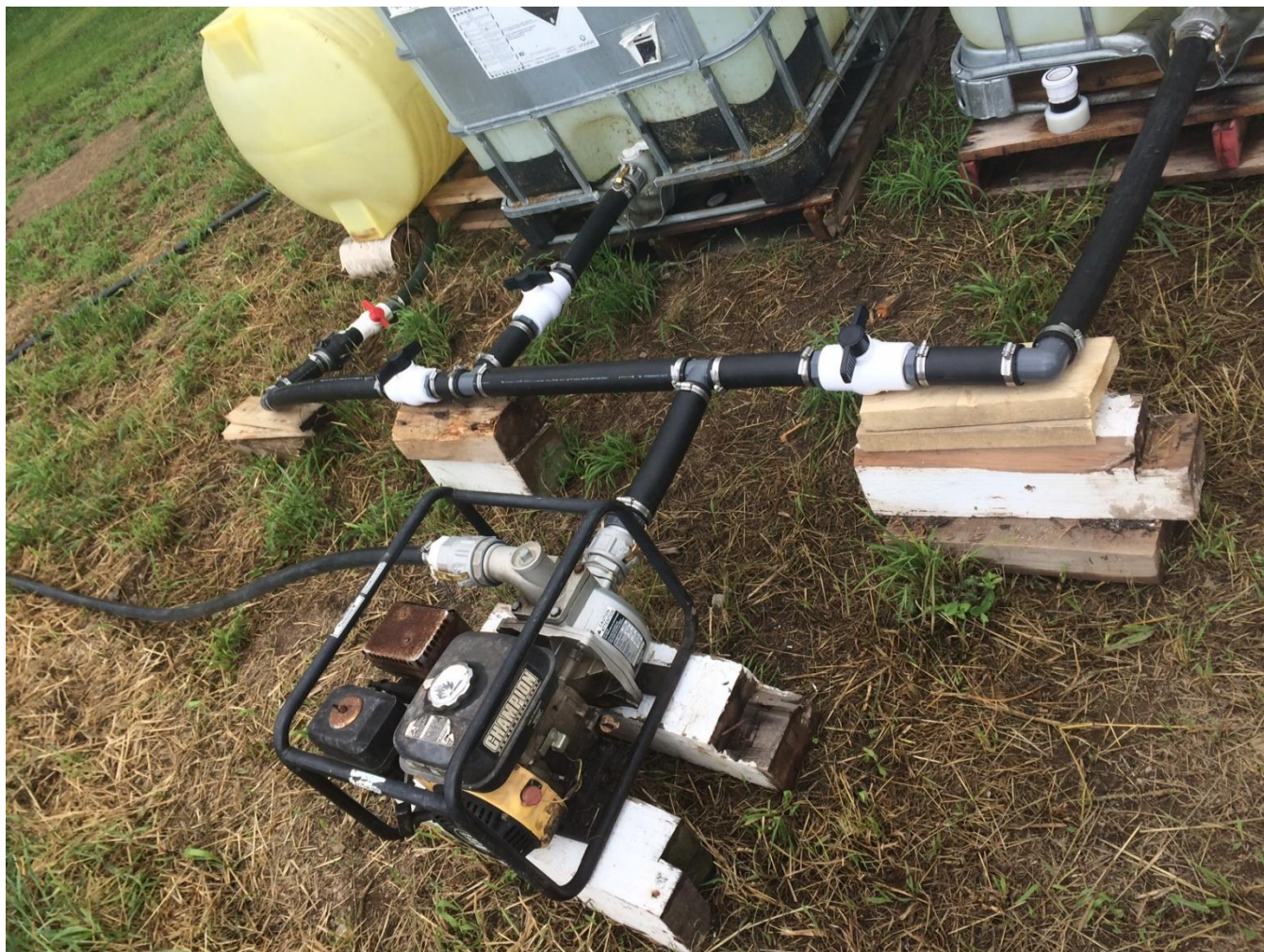
Annexe 1. Système de fertigation composé de 3 bassins pouvant être utilisés indépendamment afin d'effectuer les fertigrations selon le traitement requis, juin 2017, Ferme Jean-Pierre Plante.
