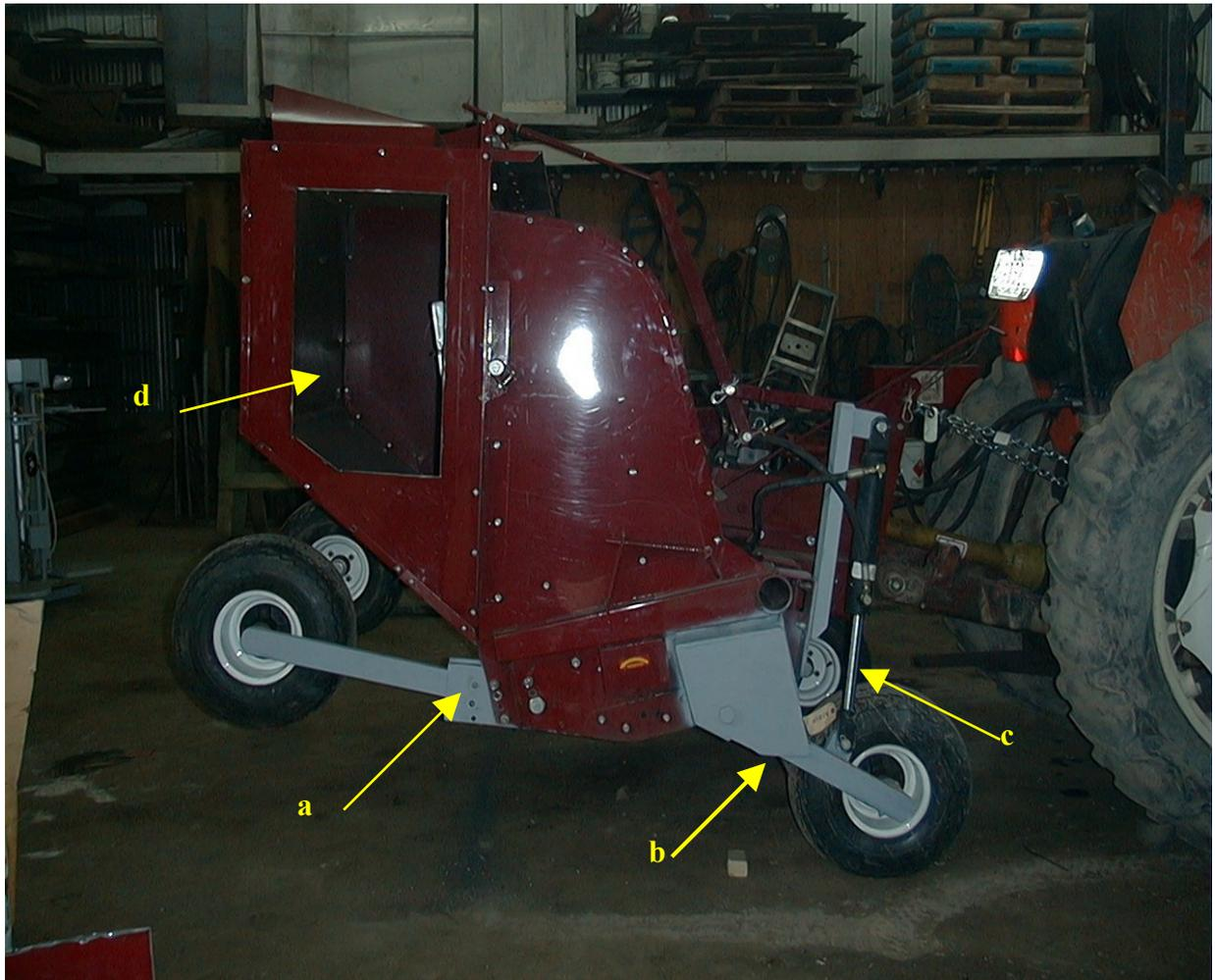
a: remplacement du cylindre porteur fixe, par des roues arrière à hauteur réglable en 3 points.
