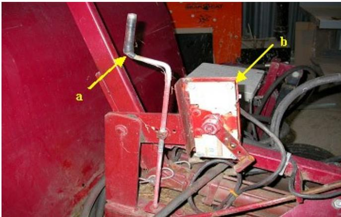
Photo 6 : Fourche de détection du profil du sol maîtrisant sa variation par le mini-interrupteur « micro-switch » pour maintenir la hauteur de coupe demandée
