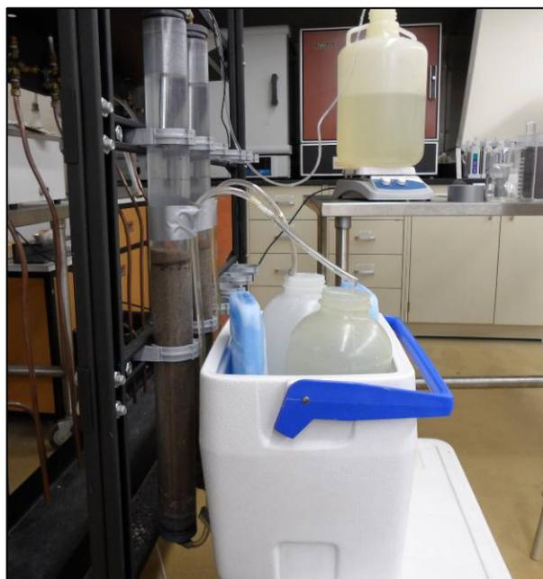
**Figure 8.** Dispositif expérimental de filtration lente sur sable à l'Université de Sherbrooke.
