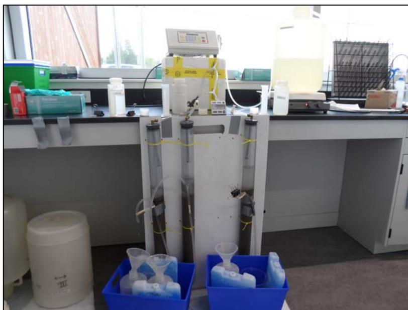
**Figure 9.** Dispositif expérimental de filtration lente sur sable au Laboratoire d'hygiène de l'environnement agricole de l'IRDA.
