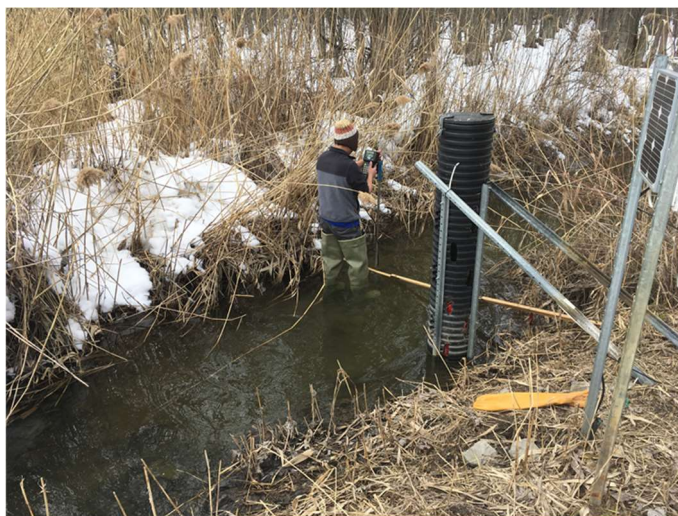
Figure 6. Mesures du débit instantané, à l'aide du moulinet hydrométrique, à la station Dix-huit Arpens.
