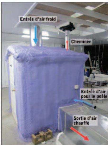
À chaque série d'essais, les intrants et les effluents (fumée et cendres) ont été échantillonnés et caractérisés. L'émission de particules, l'opacité et plusieurs gaz d'intérêt environnemental susceptibles d'être formés durant la combustion, dont CO<sub>2</sub>, CH<sub>4</sub> et N<sub>2</sub>O, ont été mesurés en continu dans les gaz éva-
