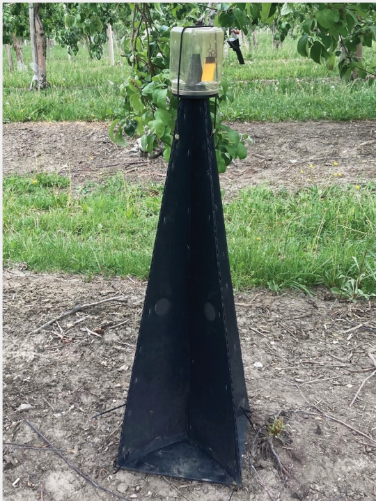
FIGURE 1 Piège pyramidal (Dead-Inn® Pyramide / piège Grower 48") (matériau = coroplaste; hauteur = 1,2 m)
