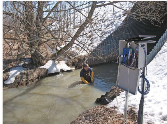
Figure 9. Dispositif d'alimentation solaire et d'enregistrement électronique des mesures provenant des sondes, installé sur la rive de la 3ePRPB.
