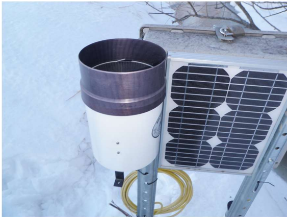
Figure 9. Dispositif d'alimentation solaire et d'enregistrement électronique des mesures provenant des sondes, installé sur la rive de la 3ePRPB.
