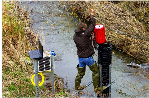
Figure 8. La sonde multi-paramètres (vue rapprochée) installée avec un dispositif de flottaison dans le tube de plastique perforé de pvc (en noir).
