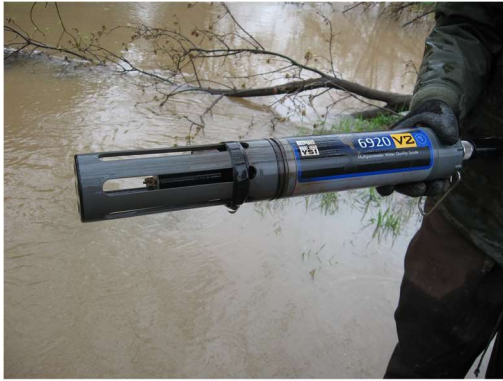
Figure 8. La sonde multi-paramètres (vue rapprochée) installée avec un dispositif de flottaison dans le tube de plastique perforé de pvc (en noir).
