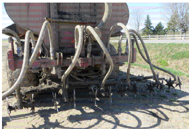
Figure 3. Équipement d'incorporation rapide sur la citerne (photo : Agrinova)
